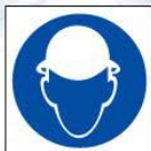
M02 Работать в защитной каске (шлеме)
