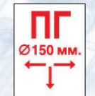
F30 Пожарный гидрант
