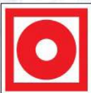
F10 Кнопка включения установок (систем) пожарной автоматики
